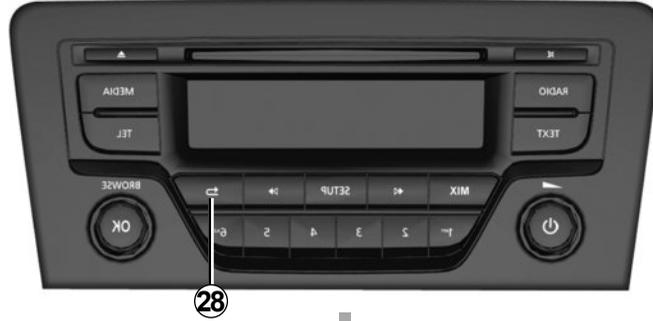
للتعطيل، اضغط على الزر «١» أو «٢» بلوحة مفاتيح نظام الصوت مرةً أخرى أو اضغط على الزر **28** الموجود باللوحة الأمامية لنظام الصوت. ينطفئ المؤشر «MIX».
